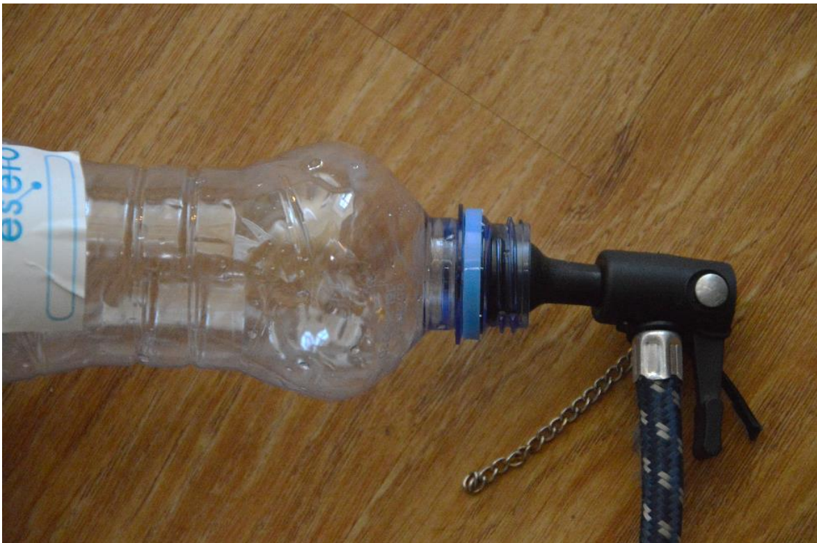
Obr. 1: Bezdušový ventilek v hrdle PET-lahve
