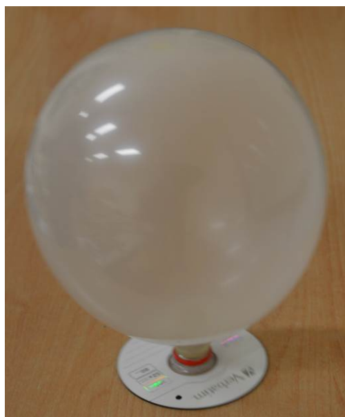
Obr. 1: Vznášedlo vyrobené pomocí CD, ústí PET-flašky, lepidla a balónku.
