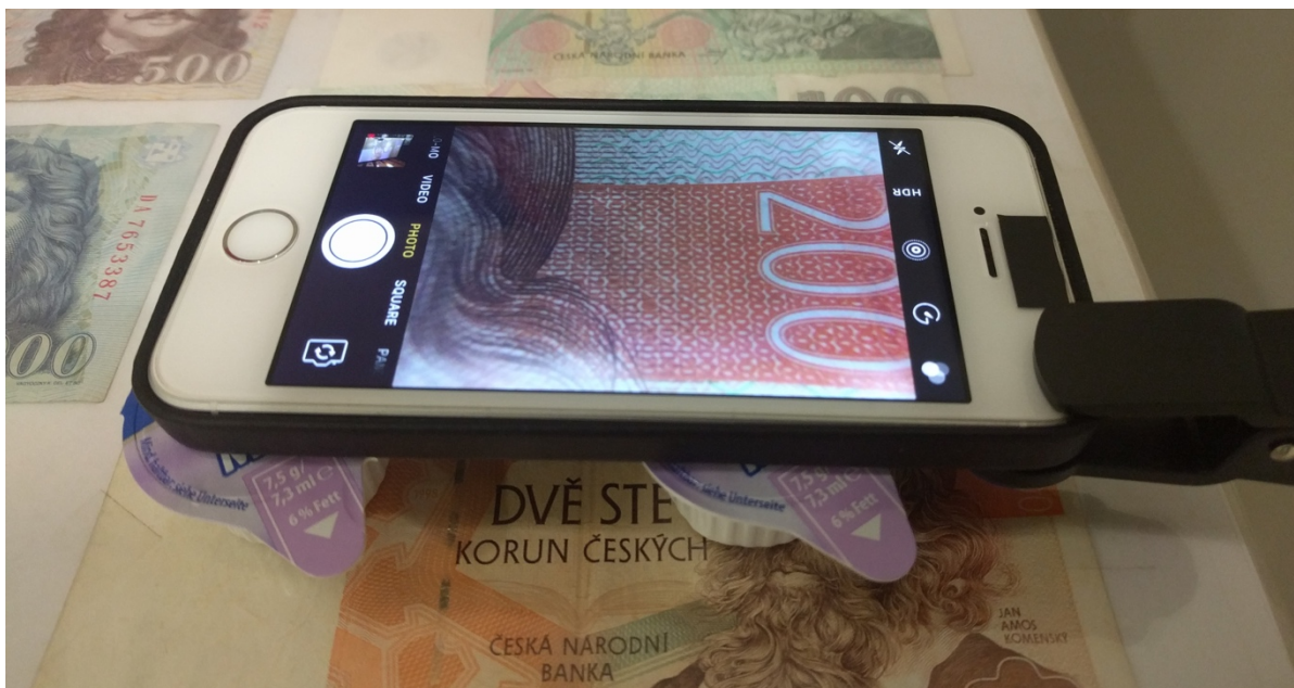
Obr. 2.: Mobilní telefon jako lupa. Na obrázku je možné vidět mikrotisk na 200 korunové bankovce
