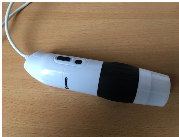
Obr 3.: USB mikroskop. Jeden z jednodušších USB mikroskopů. K tabletu se mikroskop připojí pomocí redukce na mikroUSB.
